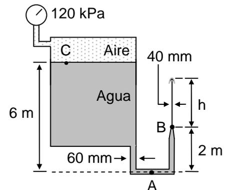
Nota: Suponga que el agua se comporta como un fluido ideal de densidad 1020 kg/m<sup>3</sup> y que son despreciables todas las pérdidas de energía. Considere que el nivel del agua del depósito no cambia y tome  $g=9.81 \text{ m/s}^2$ .
